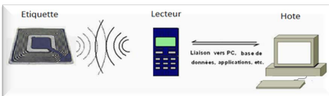
Figure 3 : fonctionnement d'un système RFID
