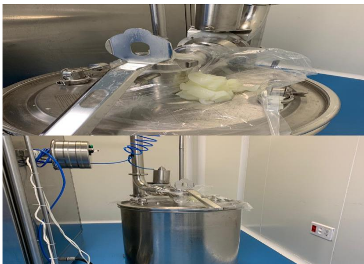
Figure N°38 : Illustration de la fuite dans le dispositif de transfert du vrac
