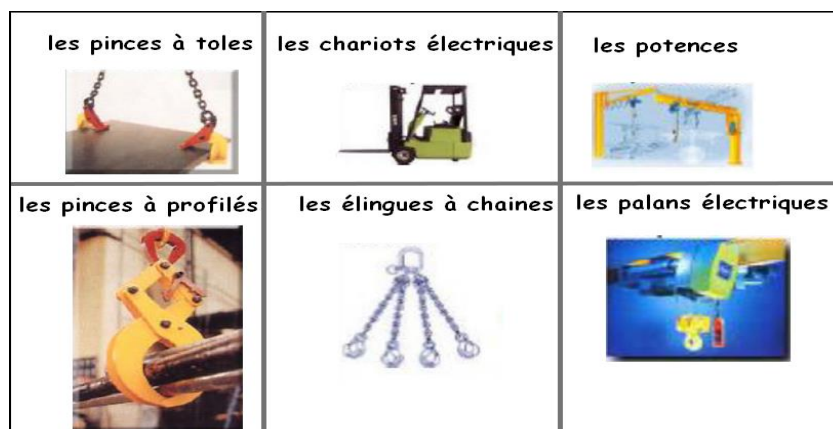
Figure I-9 : les outils de la manutention 2
