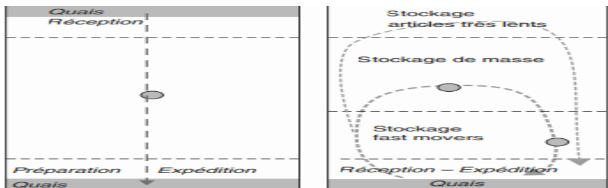
Figure N°3-1 : Conception d'un entrepôt séparant ou non réception et expédition.
