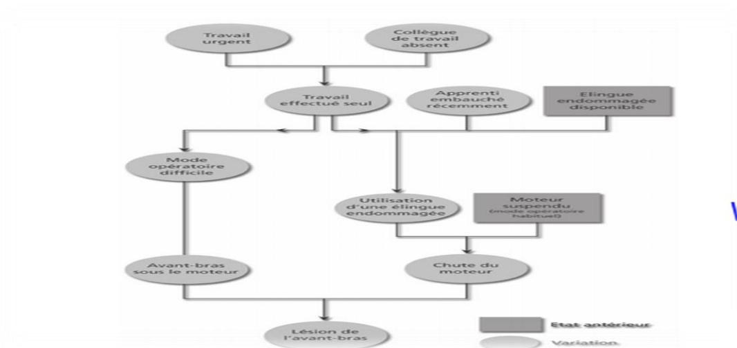
Figure n°03 : L'arbre des causes d'un accident
