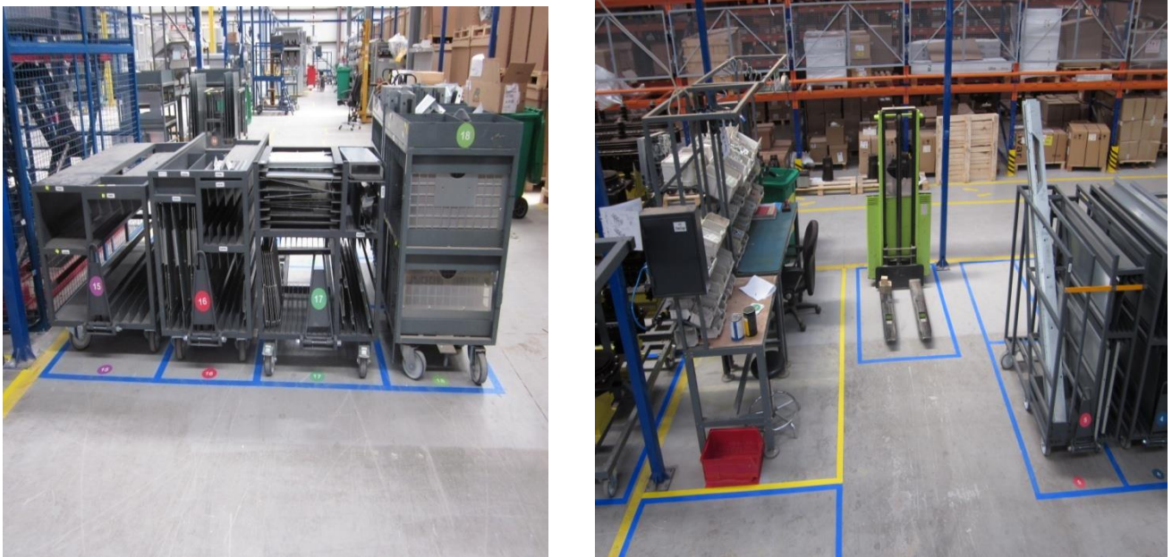
Figure N°14: L'opération de marquage de sol
