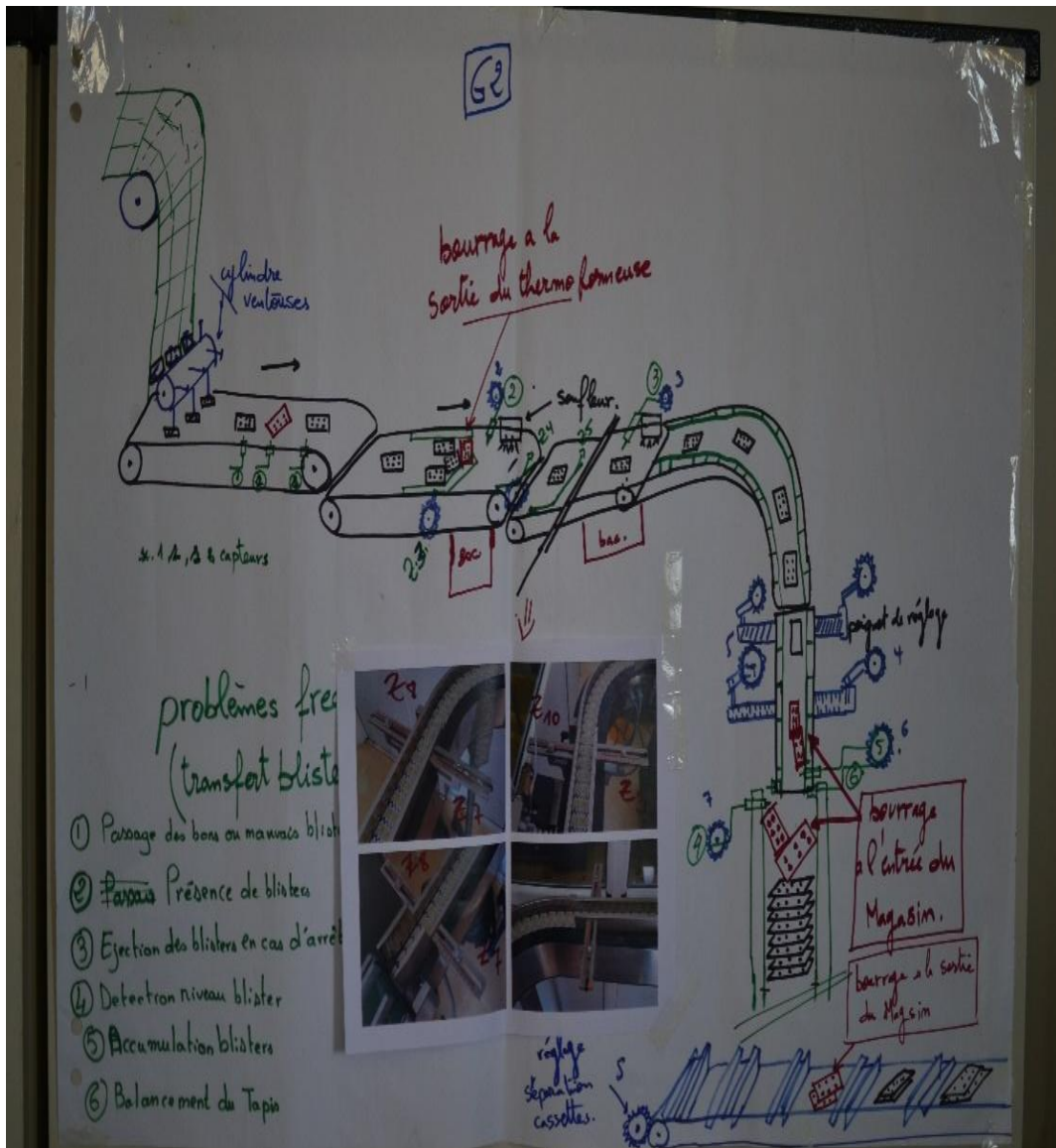
Annexe 3 : Schéma illustrant les points de réglages et les capteurs transfert blister
