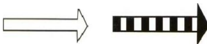
Figure III.7 : Flèche de camionnage et de matière
