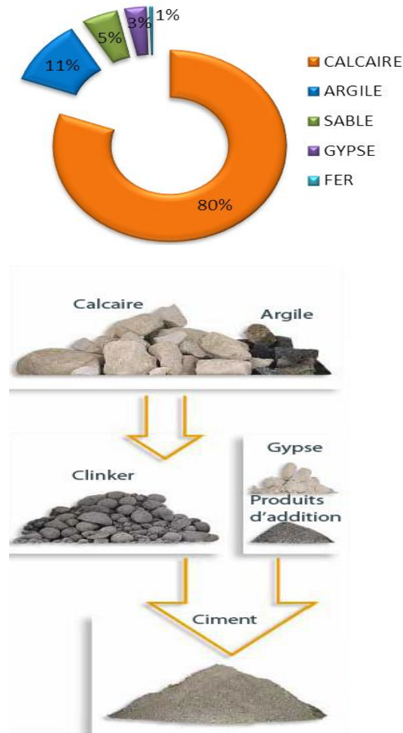
Figure N° 3 : Les matières composantes du ciment
